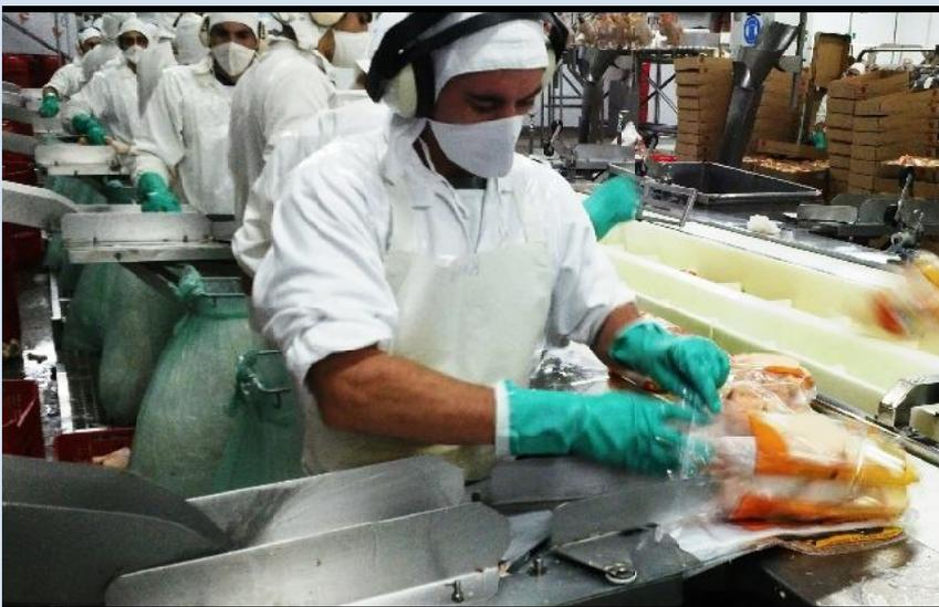
La operación se puede realizar manualmente, aquí el pollo se desliza sobre una mesada de chapa y cae por un agujero con forma de embudo. Debajo de éste, otro trabajador coloca la bolsa para su empaque y la tarea de cierre.
